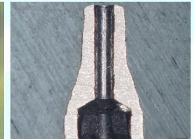
電子基板部品の切断
